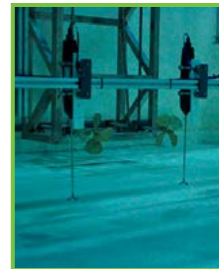
Ensayos de propulsión de doble hélice para estudio del campo de velocidades generado sobre fondo rígido y sobre fondo móvil (@iCIEM)
