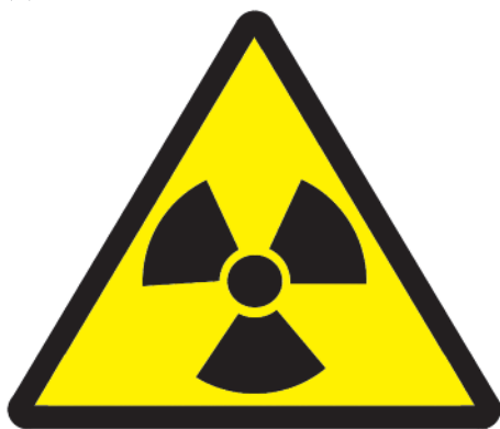
Figura A1.7. Señal de peligro que indica la presencia de radiación ionizante.
