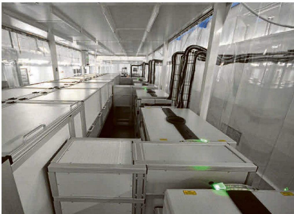
Interior del láser de petavatio cubierto para proteger las lentes que forman la instalación. | BARROSO
