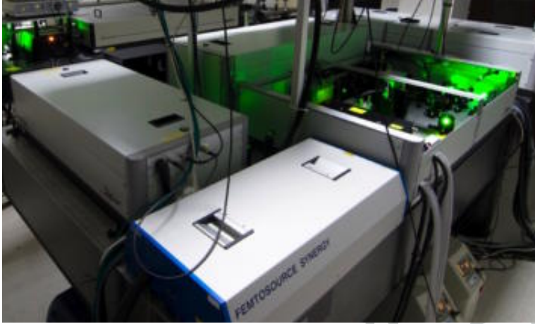
Figura 9.2. Sistema CPA de 20 teravatios a 30 femtosegundos. En primer plano se observa el oscilador de mode locking. La parte abierta es el amplificador.
