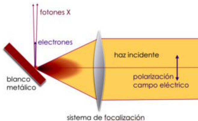
Figura 8.2. Sistema típico de focalización para pulsos de milijulio y duraciones por encima de 100 fs.
