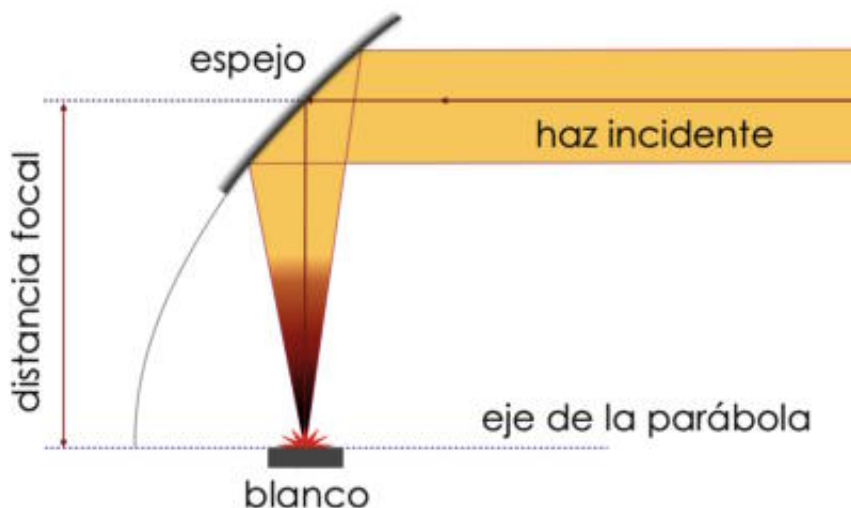
Figura 6.3. Focalización con un espejo parabólico fuera de eje que funciona con un ángulo de 90 grados. El blanco se sitúa en el foco de la parábola.
