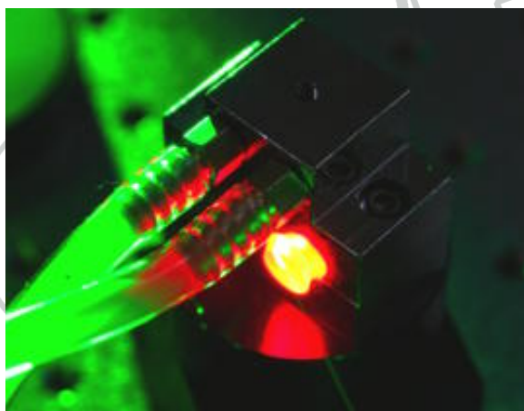
Figura 8.1. Cristal amplificador de titanio zafiro. Este cristal tiene casi un centímetro de diámetro y amplifica hasta 2 mJ por disparo a 1 kHz. Los tubos de la izquierda son el sistema de refrigeración por agua en circuito cerrado.
