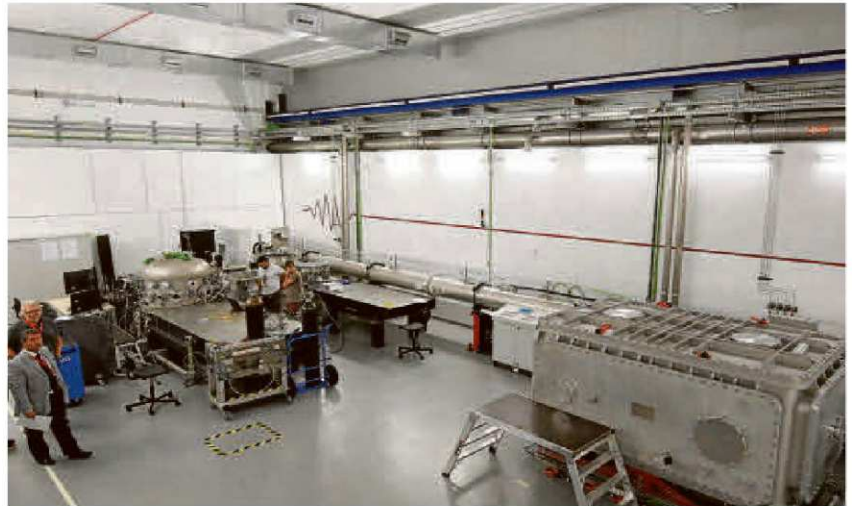
La tercera de las partes de láser donde se sitúa el transportador del haz y la cámara de experimentación.
